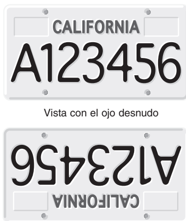
Figura 12. La vista a través de un telescopio reflector está invertida. Esto es cierto para el SkyQuest XT4.5. No obstante, la vista a través del telescopio buscador de imagen correcta tendrá el lado correcto hacia arriba, orientada de la misma manera que se observa con el ojo desnudo.
