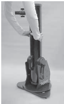
Figura 5. Ajuste el tubo óptico de la “cuna” de la base de manera que los rodamientos laterales de altura del tubo se apoyen sobre las “almohadillas” de plástico blanco. Coloque el telescopio tal como se indica de forma que no se caiga antes de instalar y acoplar el sistema CorrecTension.
