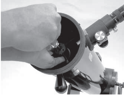
Figura 17. Para centrar el espejo secundario bajo el enfocador, sostenga el soporte del espejo secundario en su lugar con los dedos mientras ajusta el tornillo central con el destornillador Phillips. No toque la superficie del espejo.
