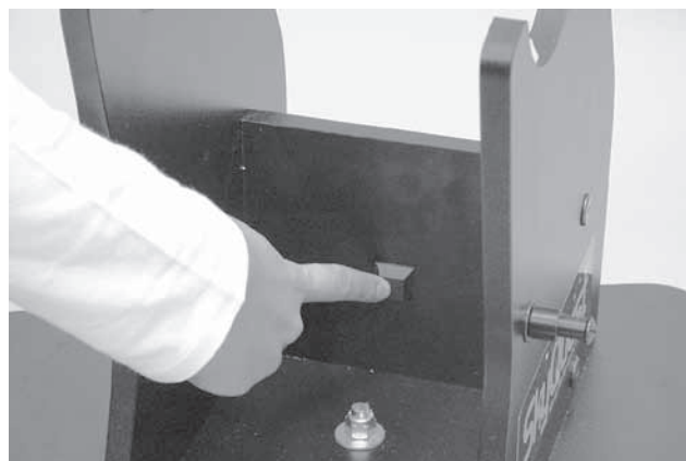
Figura 3. Coloque el tope de goma sobre la marca de índice en la superficie interior de la abrazadera delantera.
