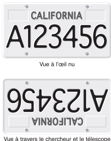
Figure 5. La vue à travers le chercheur et le télescope réflecteur est inversée (rotation de 180°). C'est également le cas pour le SpaceProbe130 mm et son chercheur.
