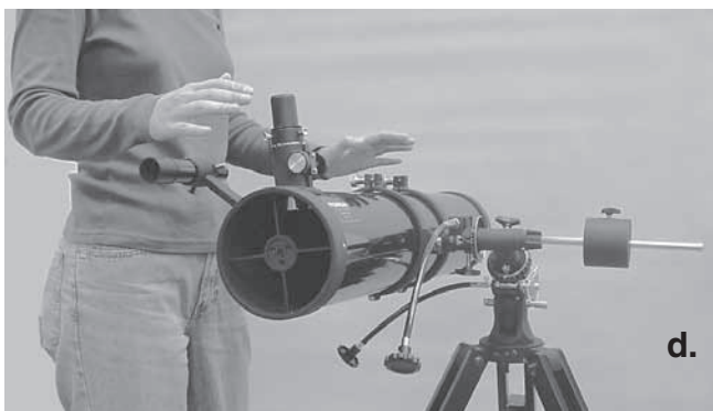
Figure 4a, 4b, 4c, 4d. L'usage correct de la monture équatoriale exige que le tube du télescope soit équilibré sur les deux axes d'ascension droite et de déclinaison. (a) Avec le bouton de blocage de l'ascension droite déverrouillé, faites glisser le contrepois le long de la barre de contrepois jusqu'à ce qu'il équilibre tout juste le tube. (b) Lorsque vous le lâchez des deux mains, le tube ne doit pas s'incliner vers le haut ni vers le bas. (c) Avec le bouton de blocage de la déclinaison déverrouillé, desserrez les fixations de verrouillage des bagues du tube de quelques tours et faites glisser le télescope vers l'avant ou vers l'arrière dans les bagues de tube. (d) Lorsque le tube est équilibré autour de l'axe de déclinaison, il ne bouge plus quand vous le lâchez.
