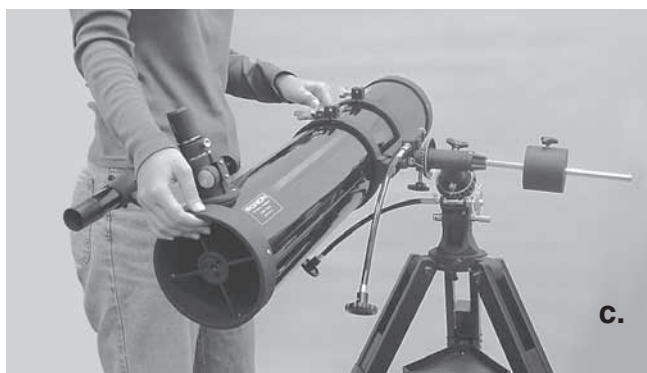
Figure 4a, 4b, 4c, 4d. L'usage correct de la monture équatoriale exige que le tube du télescope soit équilibré sur les deux axes d'ascension droite et de déclinaison. (a) Avec le bouton de blocage de l'ascension droite déverrouillé, faites glisser le contrepois le long de la barre de contrepois jusqu'à ce qu'il équilibre tout juste le tube. (b) Lorsque vous le lâchez des deux mains, le tube ne doit pas s'incliner vers le haut ni vers le bas. (c) Avec le bouton de blocage de la déclinaison déverrouillé, desserrez les fixations de verrouillage des bagues du tube de quelques tours et faites glisser le télescope vers l'avant ou vers l'arrière dans les bagues de tube. (d) Lorsque le tube est équilibré autour de l'axe de déclinaison, il ne bouge plus quand vous le lâchez.
