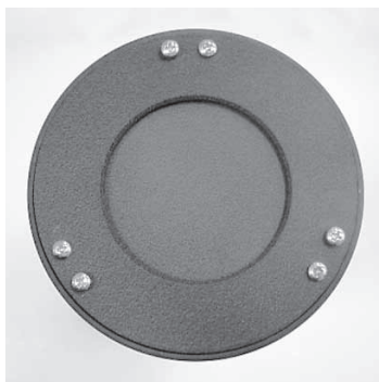
Figure 11. L'extrémité arrière du tube optique (fond de la cellule du miroir primaire). Les trois paires de vis de réglage et de vis cruciformes permettent d'ajuster l'inclinaison du miroir primaire.
