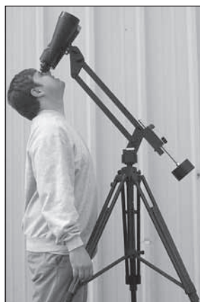
Figura 6. La montura para prismáticos se puede utilizar para ver objetos en el cenit o cerca de él. Ajuste el trípode de manera que pueda colocarse debajo de los prismáticos para ver objetos en la parte superior del cielo.
