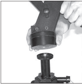
Figura 2. Alinee el eje de conexión del cabezal plano con rosca del trípode con el agujero con rosca en la parte inferior del disco pivotante. A continuación, sujete la montura para prismáticos sin moverla mientras gira el disco pivotante para enroscarlo en el eje.
