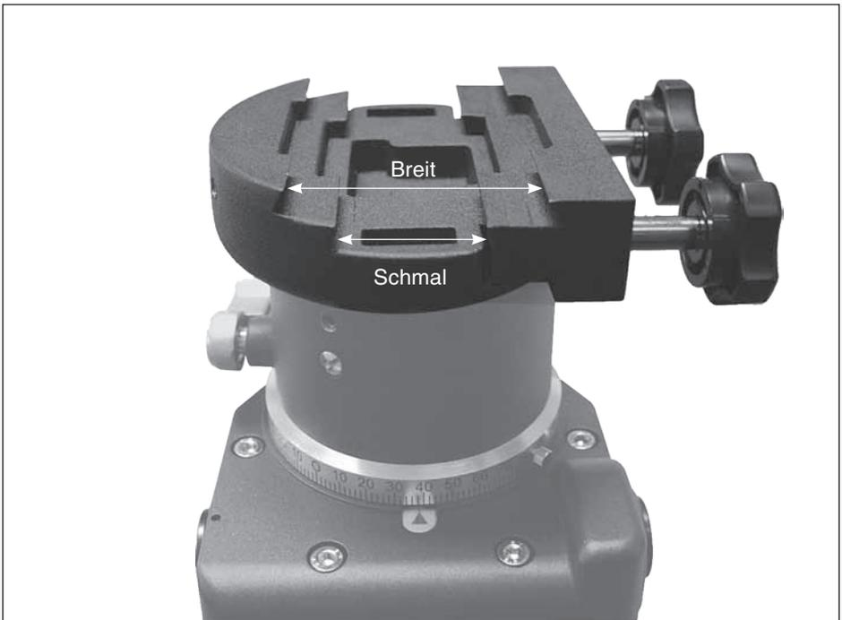
Der neue Doppel-Montierungssattel der Atlas EQ-G-Montierung.
