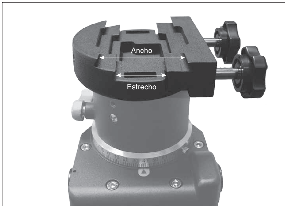
El nuevo soporte de montaje de cola de milano de doble ancho instalado en la montura Atlas EQ-G.
