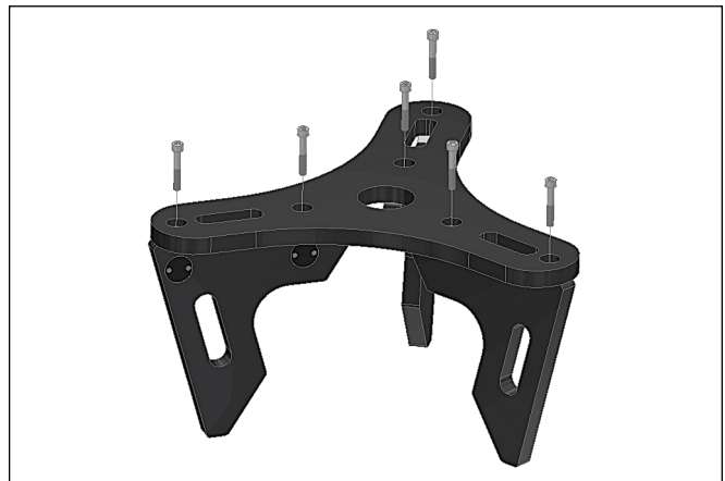
Figure 2. Assemblage des trois pieds du support Dob
