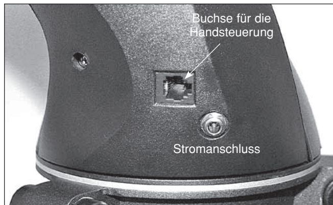
Abbildung 11. Buchsen für die Stromkabel und Handsteuerungskabel sind an der Unterseite des Montierungsarms gelegen.
