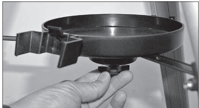
Abbildung 3. Die runde Zubehörablage wird an der Stativbeinschiene mit der unverlierbaren Schraube an der Halterung angebracht.
