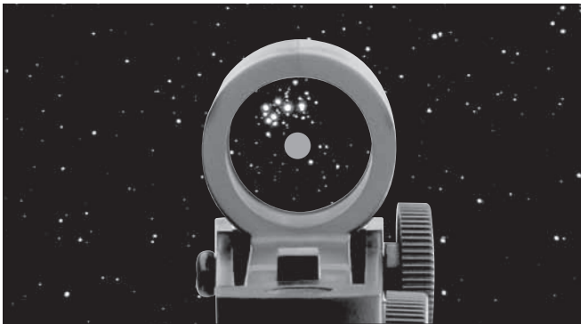
Abbildung 10. Das EZ Finder II-Reflexvisier zeigt mit einem winzigen roten Punkt am Himmel genau die Stelle an, auf die das Teleskop ausgerichtet ist.
