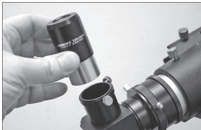
Figura 7. Inserte el cilindro cromado del ocular en la diagonal y fíjelo con los dos tornillos de mariposa. Para los modelos reflectores StarSeeker III, el ocular se inserta directamente en el adaptador de accesorios del enfocador.
