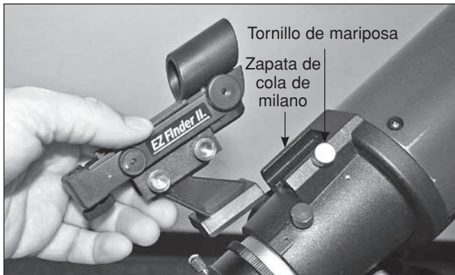
Figura 9. Inserte la EZ Finder II en su base de cola de milano en la orientación mostrada y sujétela con el tornillo de mariposa.
